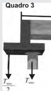
A força que age no suporte é  $F_{total} = \frac{T_{max}}{2} + T_{max} = \frac{3 \times T_{max}}{2}$
